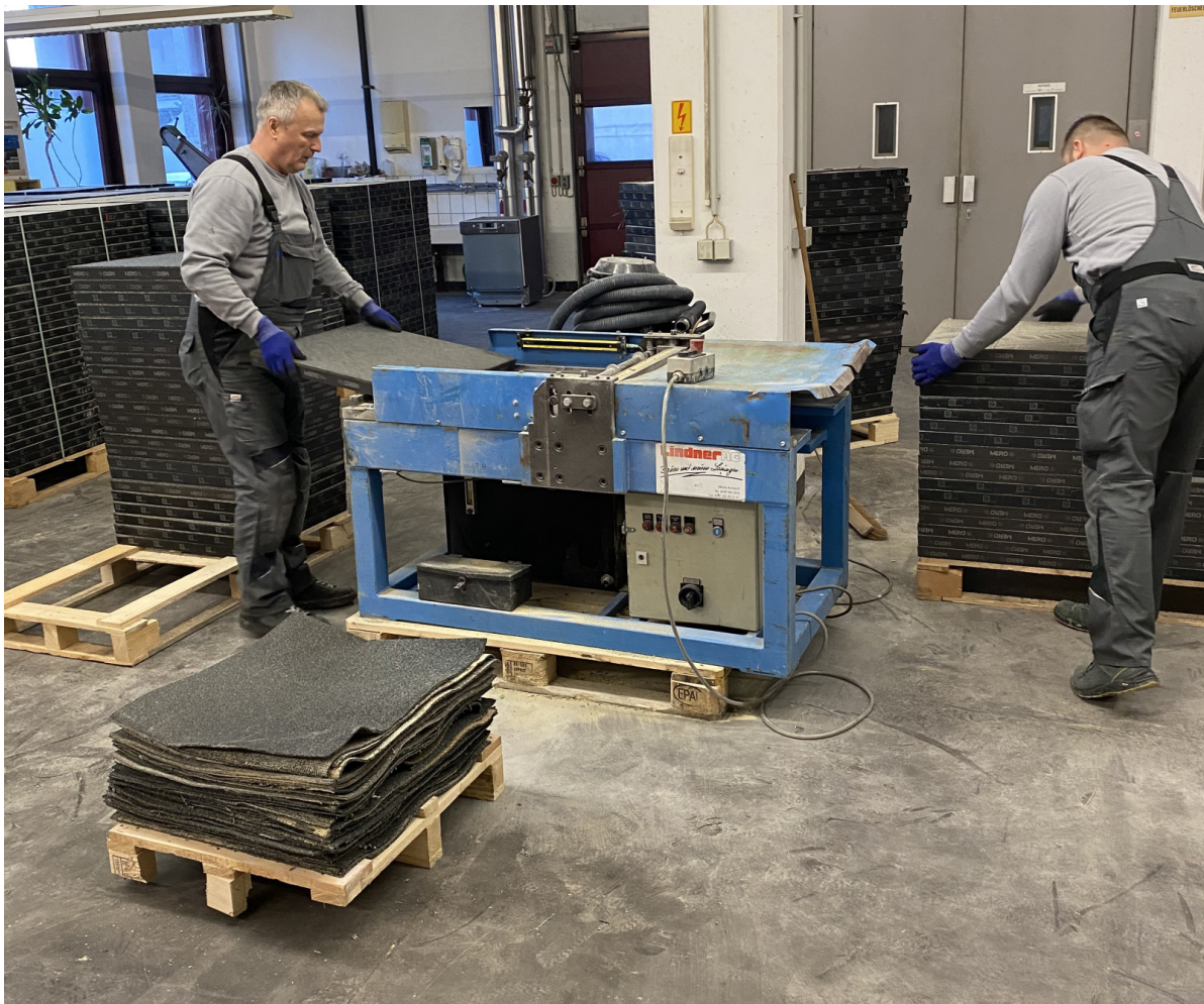
Abbildung 9: Schälen gebrauchter Bodenplatten. Projektbeispiel: Kempelenpark, 1100 Wien, © Lindner Group
