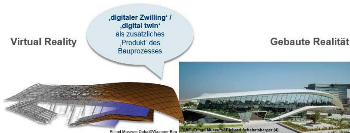
Abb. 1: Technische und „historische“ Informationen über das Gebäude und seine Komponenten sind in der „Virtual Reality“ als „digital twin“ verfügbar
