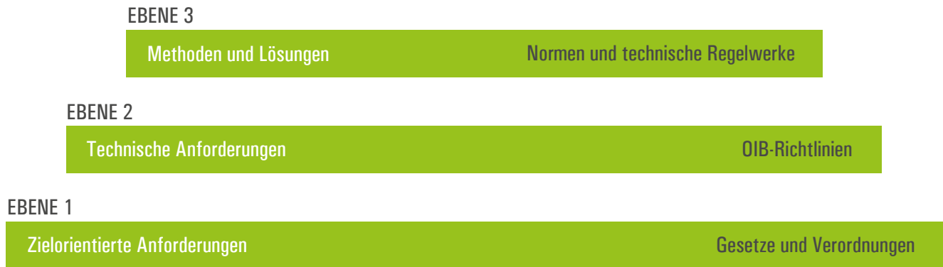
Abbildung 2: Stufenbau der leistungsorientierten, bautechnischen Vorschriften.
